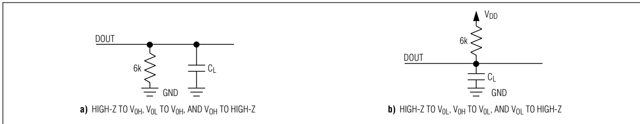
図1. イネーブル及びディセーブル時間の負荷回路
